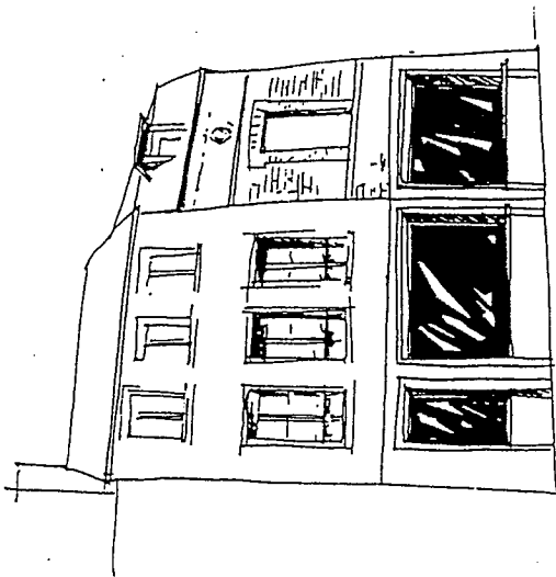
bon exemple de façade commerciale qui respecte la structure et le dessin initial de la façade de l'immeuble
