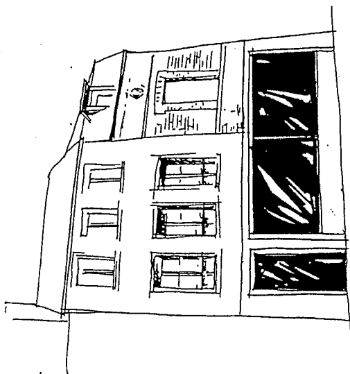
mauvais exemple de façade commerciale qui ne respecte pas la structure et le dessin initial de la façade de l'immeuble
